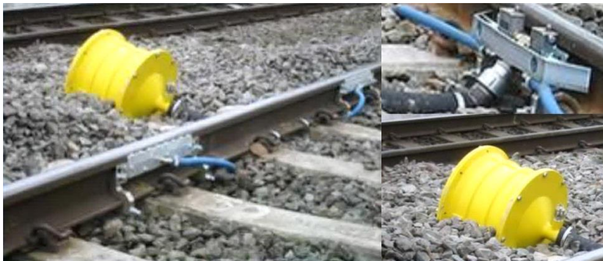
Рис. 5 – Стационарний колійний рейкозмащувач «Rail Lubricurve 50»
